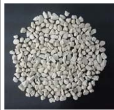
日射吸収しにくい 特殊遮熱セラミックス骨材 タフバーン® 灰白
